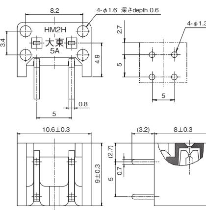
プリント基板実装穴寸法図
