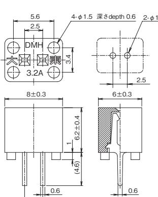
プリント基板実装穴寸法図
