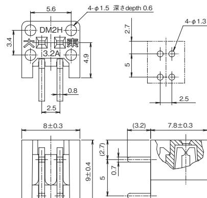
プリント基板実装穴寸法図
