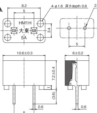
プリント基板実装穴寸法図
